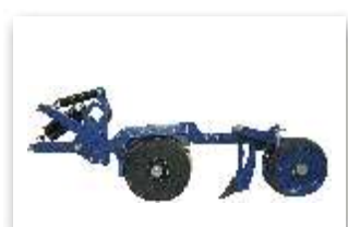
5 - SEMENTE: Sulcador de haste-facão. ADUBO: Disco duplo desncntrado 15"
