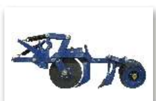
13 - SEMENTE: Sulcador de haste-facão ADUBO: Disco de corte 17" e sulcador de haste-facão
