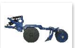
6 - SEMENTE: Sulcador de haste-facão. ADUBO: Disco de corte 15" ou 17"
