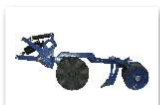
9 - SEMENTE: Sulcador de haste-facão. ADUBO: Disco de corte ondulado 17"
