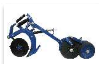
11 - SEMENTE: Disco duplo desncntrado 15" ADUBO: Disco de corte 15" e sulcador de haste-facão
