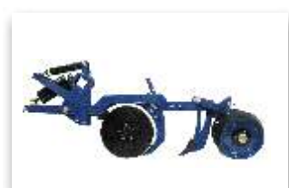
4 - SEMENTE: Sulcador de haste-facão. ADUBO: Disco de corte 15" e sulcador de haste-facão
